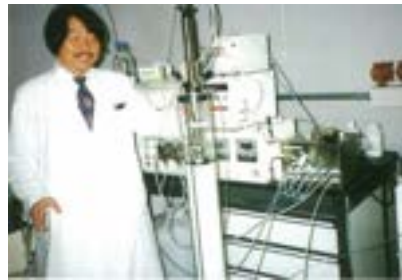
大型カラムクロマトグラフィ装置による生理活性物質の分離精製
