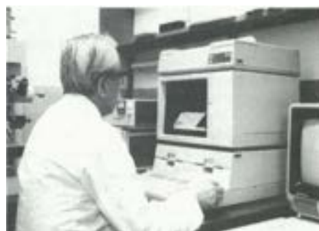
顕微分光測光システム 組織染色標本の吸光度あるいは蛍光強度 の分布、面積などをオンラインコンピュ ータで統計処理することが出来る装置である。 第5研究部<薬学>
