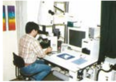
共焦点レーザー顕微鏡。 細胞の断面像の観察と三次元再構築に威力を発揮している。
