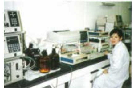
HPLC装置による抗菌性物質の単離
