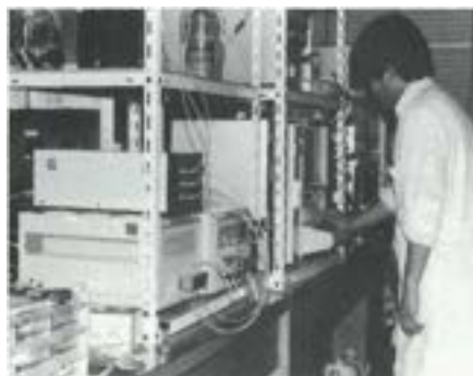
生体物質の分析や分離に活躍する高 速液体クロマトグラフィー カラムに詰める充填剤や溶離液の 種類を変えることにより各種の物質 の分離、分析を従来の方法より正確 に行うことができる。 第4研究部<物理化学>
