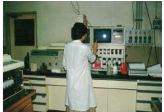
タンパク質(ペプチド)を分析する 気相フロテインシーケンサー
