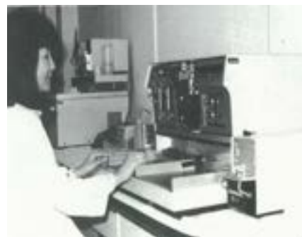
RIA用自動ピペット・ステーション ホルモン測定センター
